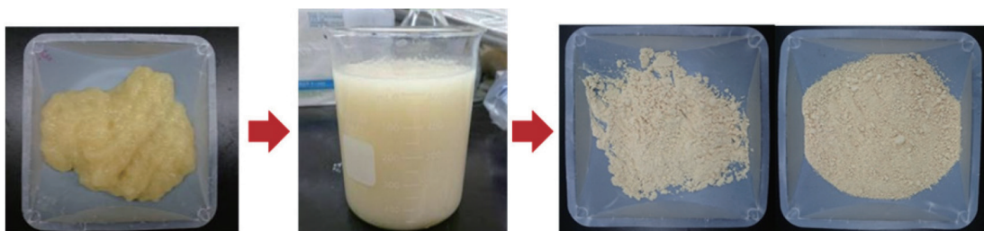
圖 3. 黑酵母 \beta -葡聚糖發酵產品外觀。從左到右分別為(1)黑酵母發酵生產 \beta -葡聚糖的高黏度濃稠發酵液，(2) 配方設計混合適當比例的賦形劑進行最佳乾燥條件探討的樣品，(3) 乾燥後含 \beta -葡聚糖粉末產品外觀， \beta -葡聚糖含量(左)16.5%、(右)22.6%
